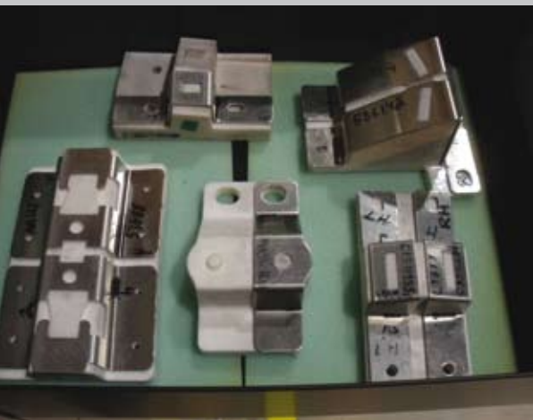
Laadunvarmistuksessa käytettäviä tarkastusjigejä.
